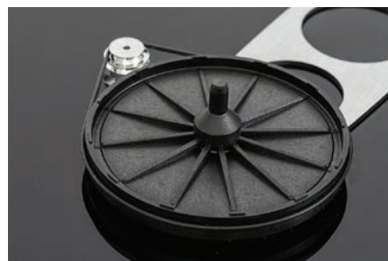
Napęd jest przekazywany krótkim paskiem na wewnętrzny subtalerz, łożysko oraz silnik wkręcono w tę samą bazę.
